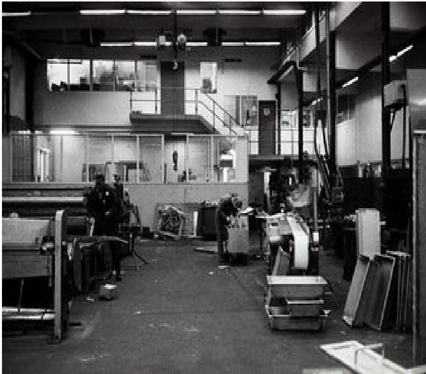
Verkstadhallen. Til venstre platesaks og knekkemaskin, til høgre sveisebåsar. I bakgrunnen bak vindauga truckverkstaden og opp trappa bak var elektrikerverkstad til høgre og vektreparatørverkstad til venstre.
